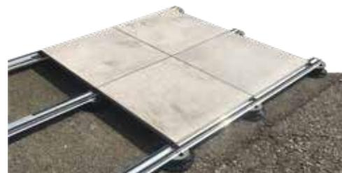
Auf einem Untergrund mit 2 % Gefälle können Platten lose in ebenfalls 2 % Gefälle verlegt werden. Bei der Verwendung des Plattenlagers wird parallel zum festen Untergrund verlegt.
