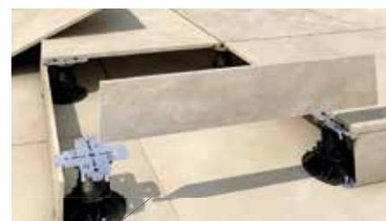
CLIP FÜR MAUERN: Der Mauern-Clip wird in unmittelbarer Nähe zu vertikalen Mauern verwendet und ermöglicht einen immer gleichen Abstand zwischen der letzten Fliese und der Mauer. Ausserdem ermöglicht die besondere Form der Stege eine Fixierung der Fliese, ohne dass diese wegrutscht. Alle Clips können nur mit Kopf mit 2 und 4 mm dicken Stegen verwendet werden.
