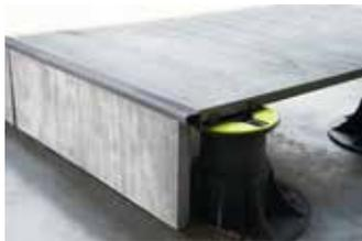
Mit dem Bordertec Abschlussprofil wird der Randbereich erhöhter Bodenbeläge mit einer vertikalen Keramikverkleidung (Setzstufe) abgeschlossen. Das Profil hat einen sichtbaren Dekorteil von 2 cm und einen kleinen, nach unten gerichteten Flügel, der die vertikale Keramik-Platte überlappt und somit die Verbindung zum Bodenbelag verbirgt.
