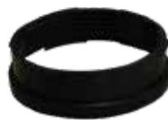
Ring um Stelzlager Standard um 30 mm zu erhöhen, bis zu 3 Ringe einlegbar, somit max. Höhe 118-148 mm
